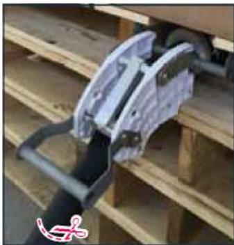
5. 关好开关装置，根据实际需要修剪橡胶管长度
