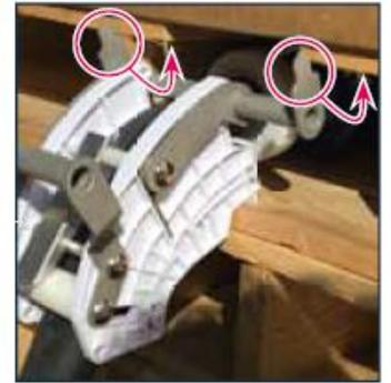
4. 开关装置上端卡住托盘中间开口处
