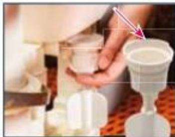
2. 将塑料袋的开关连接进料器，开关\*凸起处定位在前面
